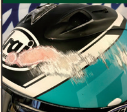
現実の衝撃での転倒痕では、ヘルメットを擦った跡が多く見られる。衝撃をかわしている証拠である。
